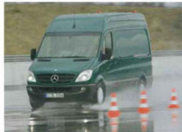
**Rutschig:** Links und rechts unterschiedlicher Fahrbahnbelag stellt die ABS-Regelung bei einer Vollbremsung auf eine besonders harte Probe.
