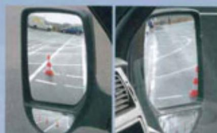
**FAZIT:** Die nicht justierbaren Nebenspiegel sind sehr klein und damit schlecht einsehbar. Die Verwendung einer Drehkonsole gesteuert von zwei abgetrennten Ausschnitten teilweise nicht für große Fahrer.
