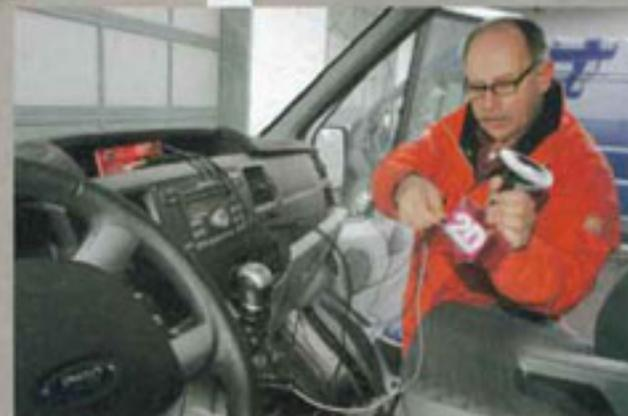
**Aufwendig:** Präzise und computergestützte Messgeräte dokumentieren jeden der vielen Dutzend Bremsversuche mit den sechs Testwagen.
