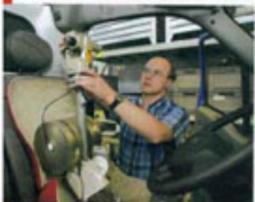
**Belastungspunkt:** Der Laser wird in Augenhöhe des 75 Kilogramm schweren Sitzdummys montiert.
