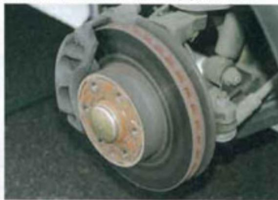
**Standard:** Groß dimensionierte und innenbelüftete Bremscheiben vorn sind das Maß der Dinge bei Basisfahrzeugen.
