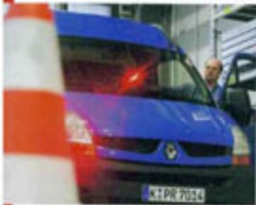
**Blickpunkt:** Bei der Sichtprüfung über die rechte Ecke wird die Spitze einer Pylone anvisiert.
