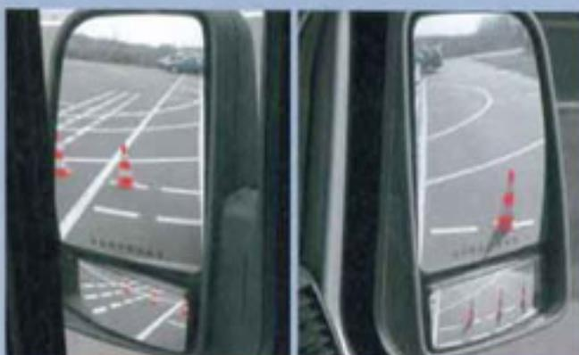
**FAZIT:** Die Standardspiegel bilden einen großen Bereich ab, was der Übersicht hilft. Diese wird durch die Weitwinkelspiegel sehr gut ergänzt. Gut zu erkennen ist die in die Hauptspiegel integrierte Anzeige des Abstandswarmer.
