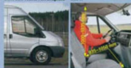
**FAZIT:** Der Ford bietet die niedrigste Kabine. Mit einer Drehkonsole kann es knapp werden. Die Kopftütze sollte etwas höher sein. Auch die Sitzlehne ist recht kurz gestrichelt. Es gibt keine Einstellmöglichkeit für das Lenkrad.
