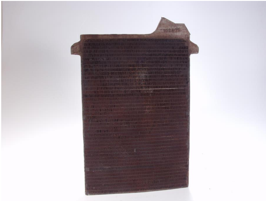
Abb. 10: Formierte positive Grooberflchenplatte
