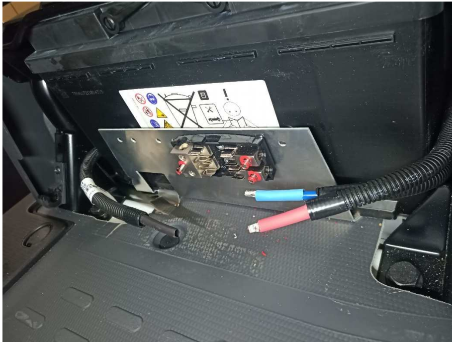
Abb. 5: Anbringen von Schrumpfschlauch
