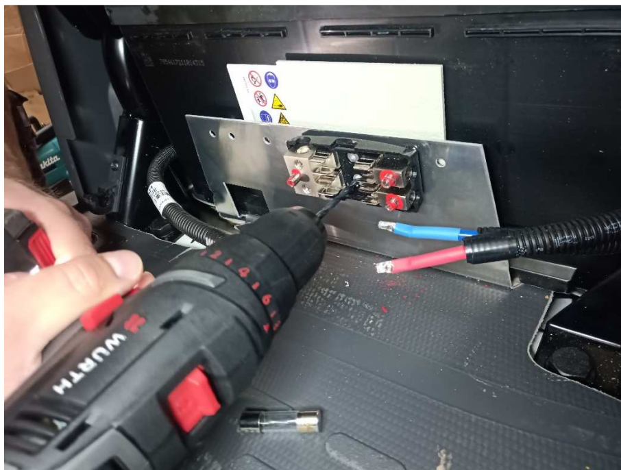
Abb. 7: Ausbohren der beiden Nieten in der Mitte des Halters (M4-Bohrer)
