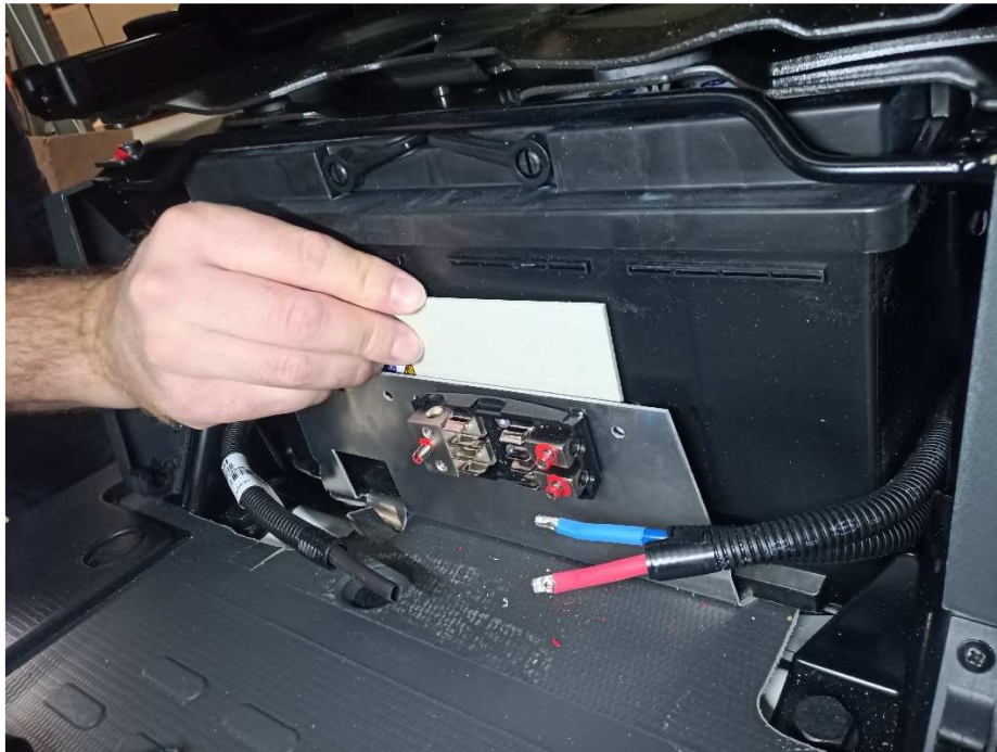
Abb. 6: Schutz der Batterie vor versehentlichem Anbohren
