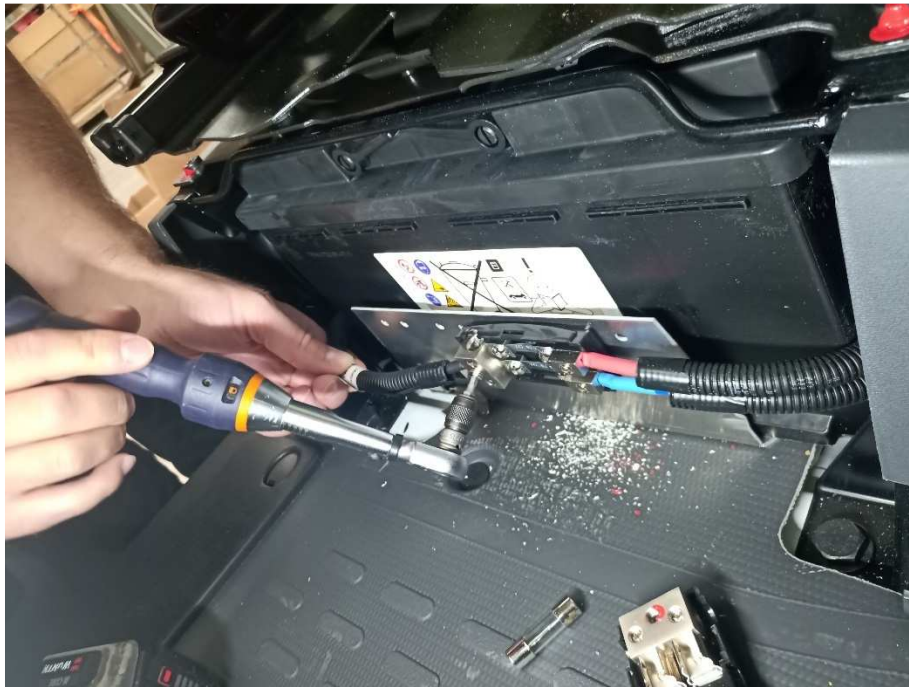
Abb. 11: Bitte auf Drehmoment und el. Eigenschutz/Isolation achten!
