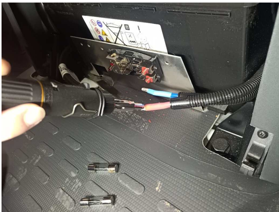
Abb. 6: Anbringen von Schrumpfschlauch (LötKolben/-Lampe o. dgl.)
