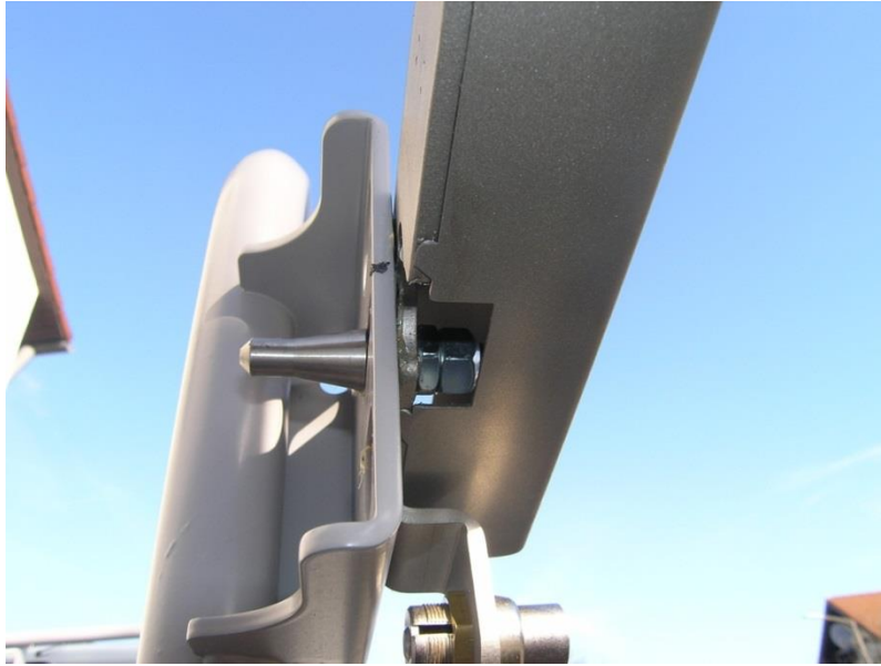
Abbildung 28: Mittels Kontermutter gesichertes Spiel des Hebelarms
