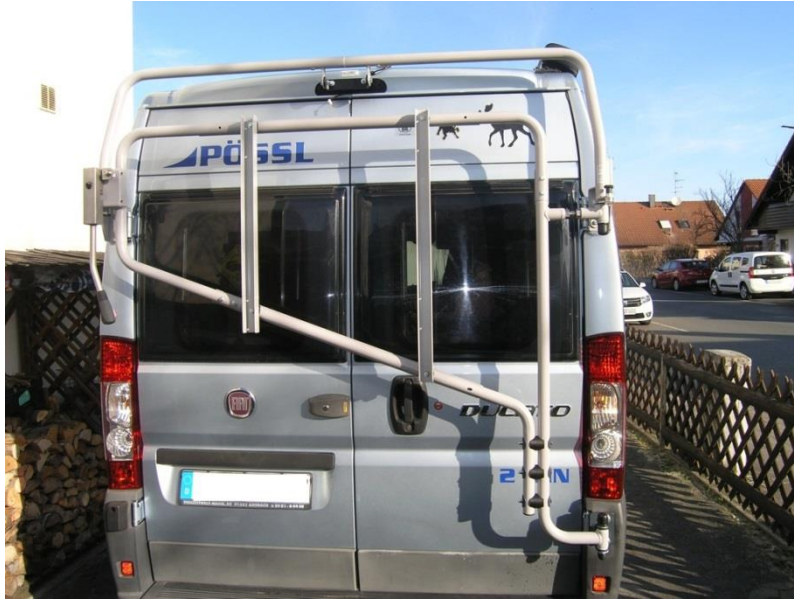
Abbildung 26: Schwenkbarer Trägerholm im fertig montierten Zustand
