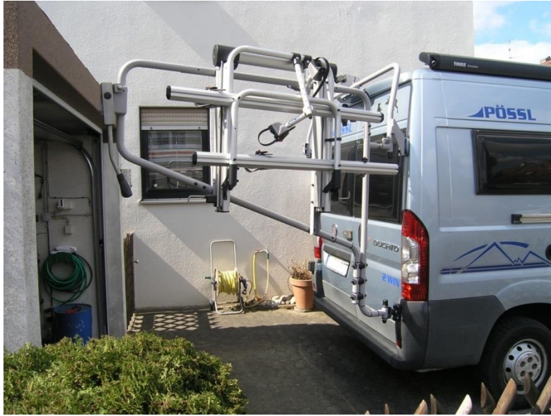
Abbildung 47: Futuro E-Lift ohne Fahrräder nach außen geklappt
