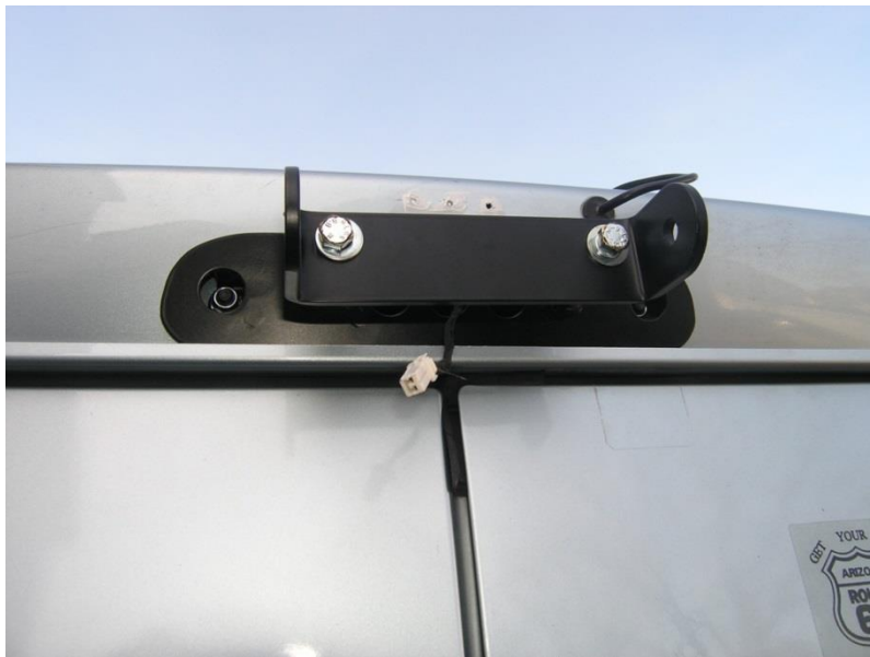
Abbildung 9 - Fertig montierte mittlere Hauptbügelbefestigung
