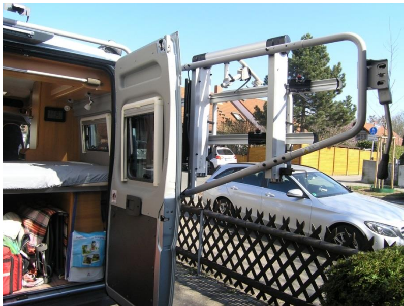
Abbildung 48: Futuro E-Lift für freien Zugang zum Heckraum nach außen geklappt
