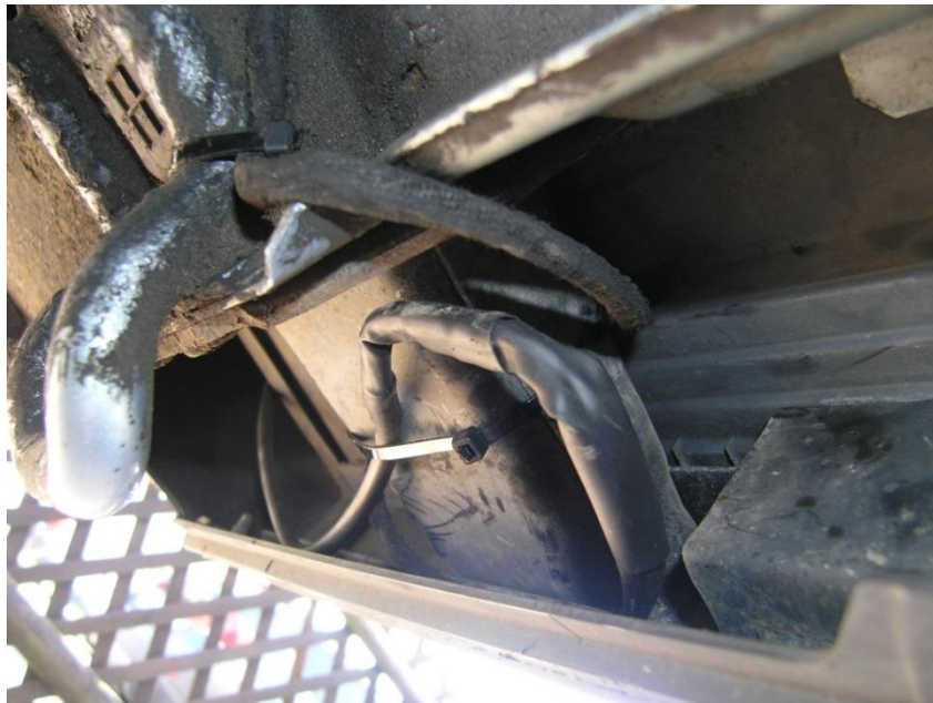
Abbildung 43: Verbindung des im Kabelbund geführten Schaltkabels mit dem E-Lift Anschlusskabel
