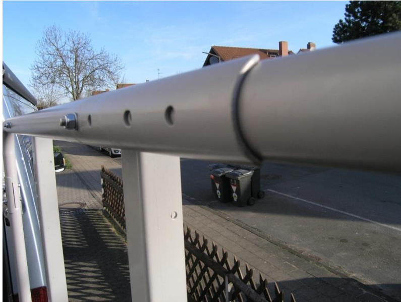
Abbildung 24: Obere Verstärkung des Schwenkarmes durch ein hinterlegtes Halbrundprofil
