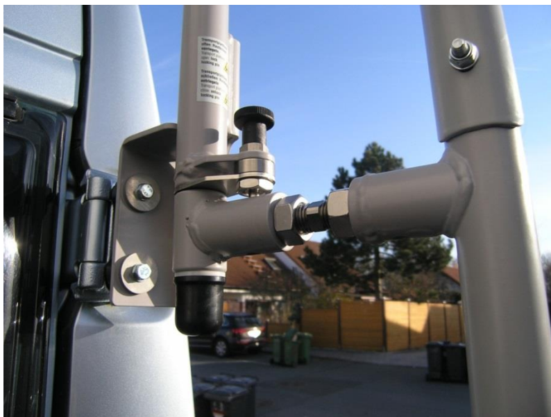
Abbildung 27: Grundeinstellung der Trägerhöhe durch Verstellen des rechts/links Gewindes
