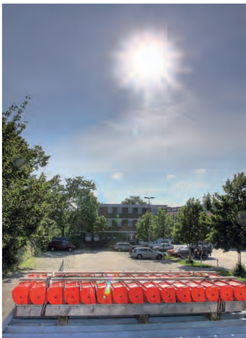
Eis und Schnee, Regen und Sonne: Unter freiem Himmel waren die Kästen fünf Jahre lang der Witterung ausgesetzt
