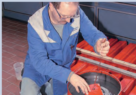
Beim zweiten Mal entschieden wir uns für ein Salz-Tauchbad. Damit war sichergestellt,...
