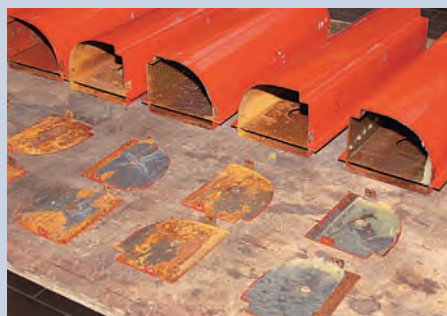
Die Seitendeckel aus (ehemals) blankem Blech dienen als Kriterium für das Haftvermögen
