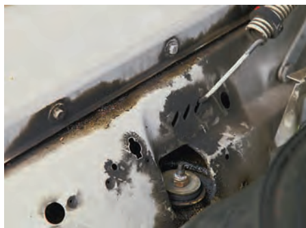
Unschön: Bei Hitze kriecht das Fett aus allen Ritzen und bindet den aufgewirbelten Straßenstaub
