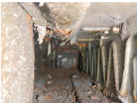
Blick in den Schweller eines topgepflegten Autos aus den Siebzigern: Den Blattrost stoppt nur Fett
