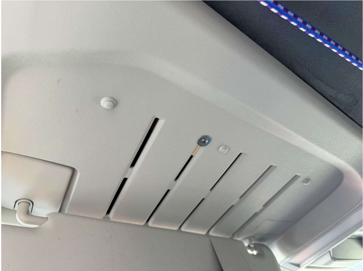
Bild 06: Fixierung des vorderen Boardauflagers mit einer Schraube M4 – verschraubt mit einer Hülsenmutter (hat einen flachen Kopf, trägt nicht auf und regelt das Spiel innerhalb der Hülse)
