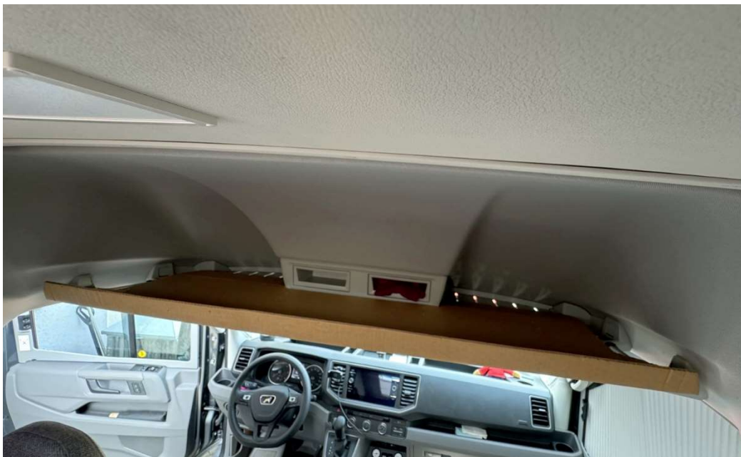
Bild 01: Schablone aus Wellpappkarton als Formmuster in Erstfassung
