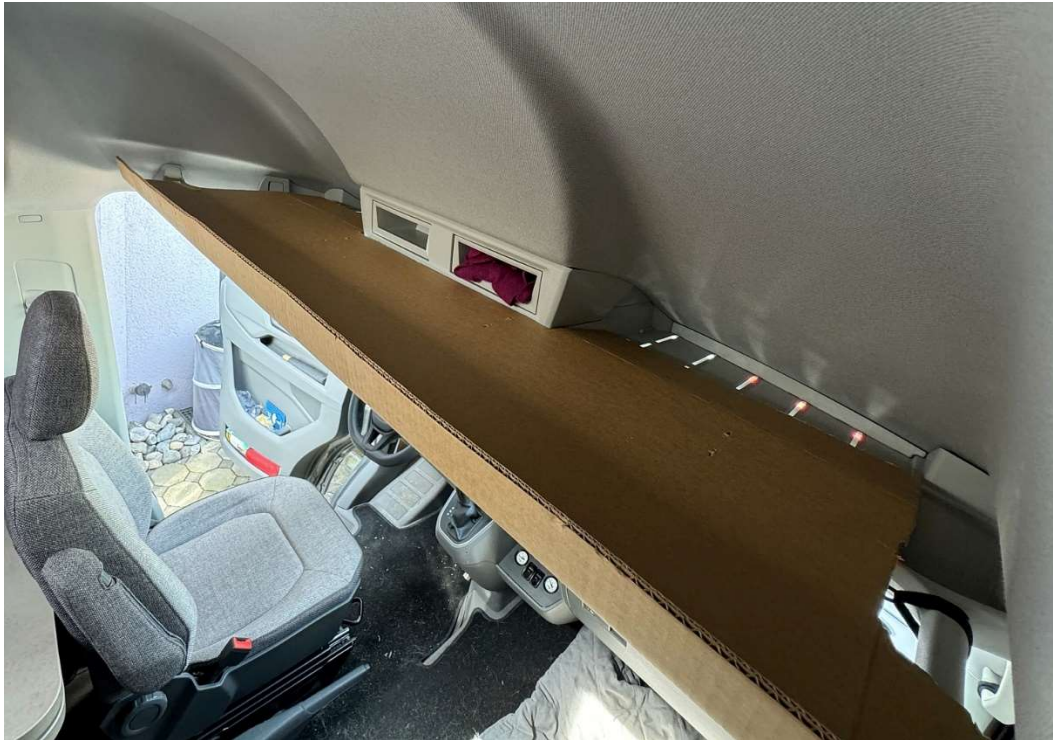
Bild 02: Schablone aus Wellpappkarton als Formmuster in Aufsicht
