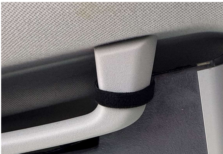
Bild 07: Fixierung mit Klettband-Kabelbinder
