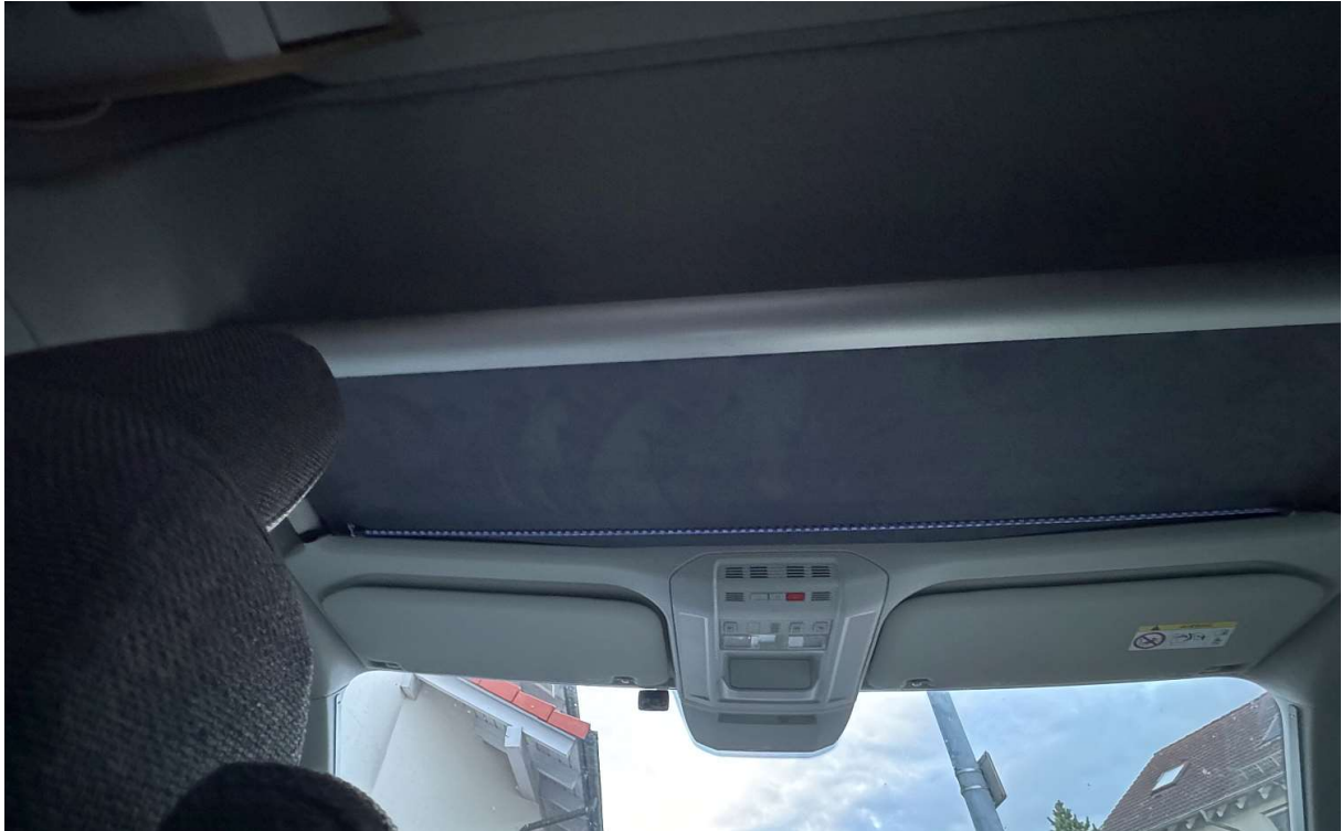
Bild 11: Untersicht des Ablageboardes (das Spannseil hat nichts mit dem Ablageboard zu tun – wir nutzen es zum Aufhängen des Trockentuches oder nachts für eine schnell entfernbare Verdunklung mit einem schwarzen Microfaserbadetuch)
