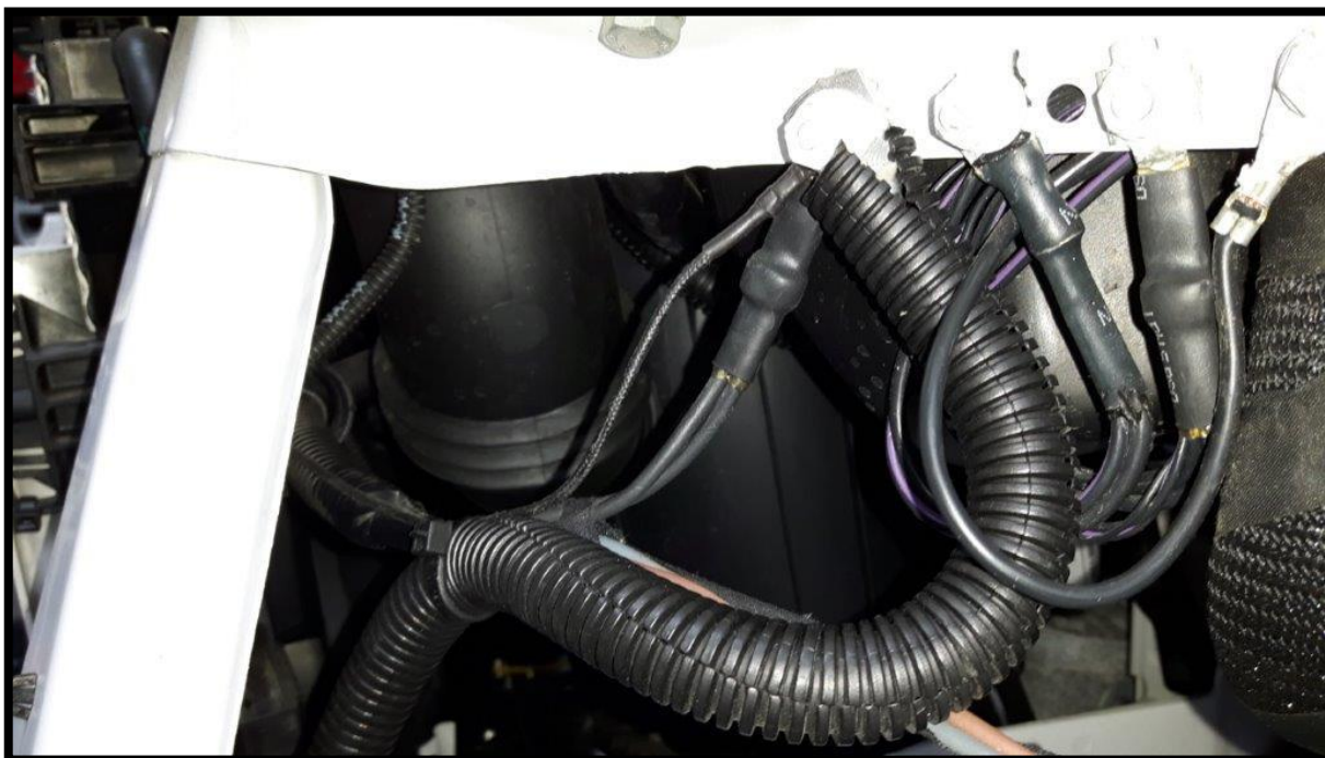
Trzy przewody (H07V-K 1x35) z końcówkami (8x35). Three wires (H07V-K 1x35) and tips (8x35).
