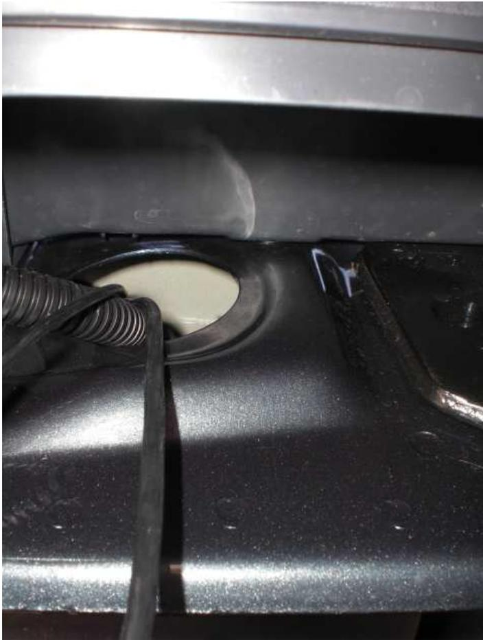
Bei mir kam da schon ein Kabel raus. Durch diese Öffnung kommt man dann wieder nach draußen und unter das Fahrzeug.
