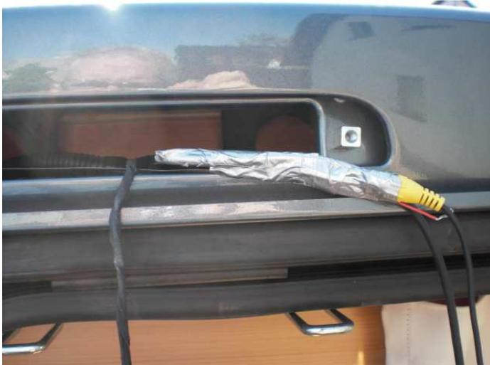
Das Kabel mit einem Einzugsdraht dann einziehen. Ob vom Bremslicht nach links in den Holm oder vom linken Holm Richtung Bremslicht muss man ausprobieren was am besten geht.
