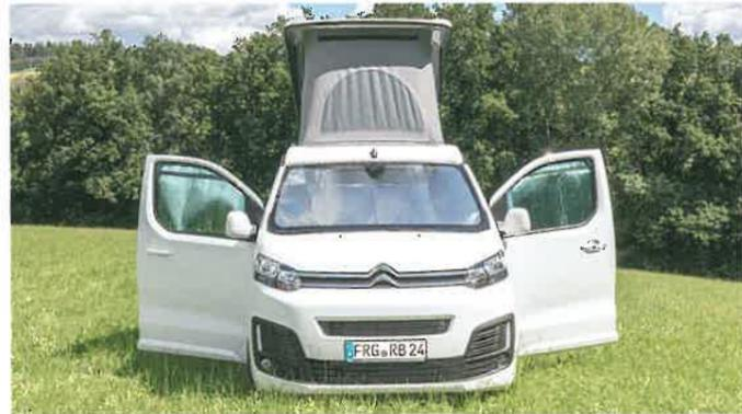
**ISOLITE Inside** für die Fahrerhausfenster. **ISOLITE** wird an der Windschutzscheibe oben mit Klettverschluss befestigt.
