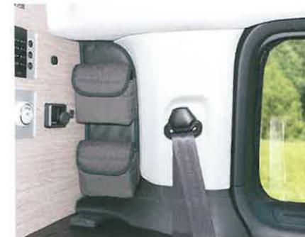
Die Original Utilities haben Taschen, die aus dem Originalstoff der **CAMPSTER**-Sitzbezüge gefertigt und mit einem speziellen Klettverschluss und Selbstkleber am Fahrzeug befestigt werden.
